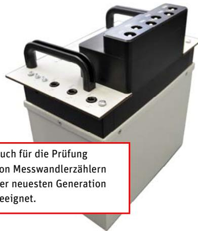
ICT127 Auch für die Prüfung von Messwandlerzählern der neuesten Generation geeignet.
